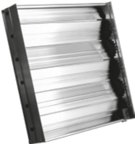
Клапан расхода воздуха изготовлен из алюминиевого профиля в виде рамки и горизонтально расположенных жалюзи, связанных между собой механизмом регулирования. Регулировка производится стандартной крестовой отверткой с лицевой стороны смонтированного изделия. КРВ устанавливается на внутреннюю часть рамки вентиляционной решетки и жестко крепится заклепками. Клапан расхода воздуха позволяет плавно и равномерно распределять и регулировать воздушный поток.
