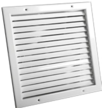
Вентиляционная однорядная алюминиевая решетка типа **SL** представляет собой решетку с одним рядом подвижных lamелей специальной аэродинамической формы, которые служат для регулирования направления потока воздуха. Изготовленные из легкого и прочного алюминиевого сплава подвижные lamели регулируются индивидуально, фиксируясь в установленном направлении, что позволяет выполнять многофункциональную регулировку потока воздуха в разных направлениях на весь срок службы решетки.
